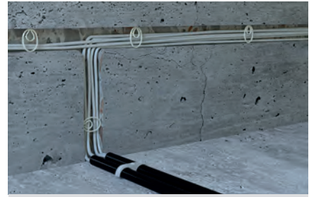
Kabelbefestigung in Wandschlitzzen < 55 mm
